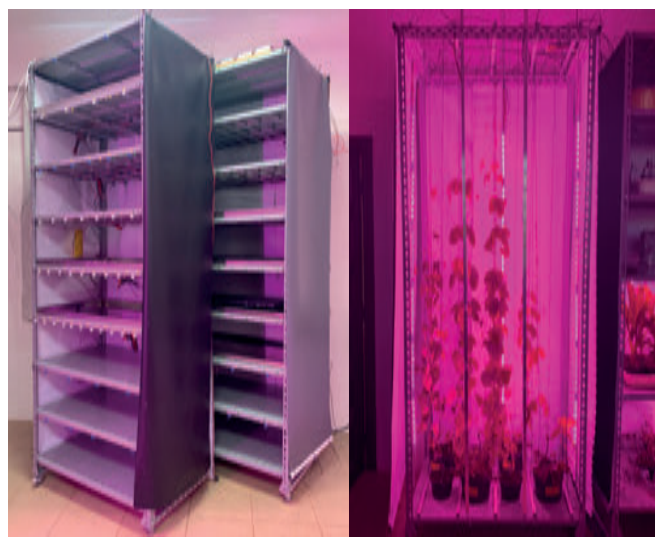
Modelo de growth chamber para o cultivo vertical indoor com layers para plantas de pequeno porte e na vertical para plantas de grande porte.
