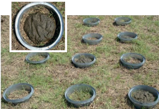
Câmaras de coleta de gases do efeito estufa emitidos por dejetos de bovinos
