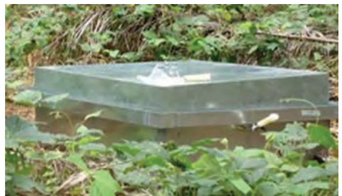
Macro câmaras de coleta de gases do efeito estufa emitidos pelos resíduos da cultura da palma, matéria-prima para a produção de biodiesel
