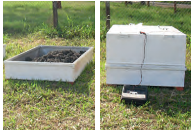
Câmaras de coleta de gases do efeito estufa emitidos pelo solo na cultura da cana-de-açúcar
